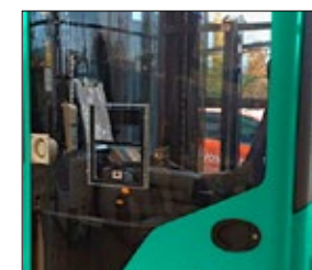
Conexiune intercom 2 căi pentru cabină de depozit rece
